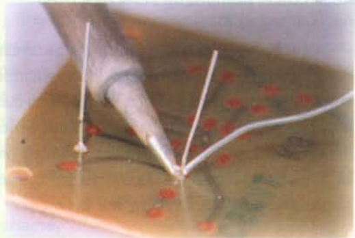
Figura 6.18. Aplicación de la soldadura. El caudín debe permanecer inmóvil
